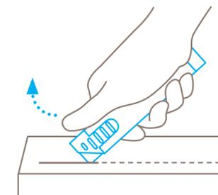
Retirez le **pouce du curseur** pour permettre la rétraction semi-automatique de la lame.
