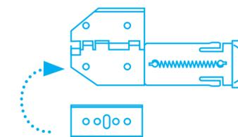
Tourner ou changer la lame, et la replacer **exactement** sur les ergots.
